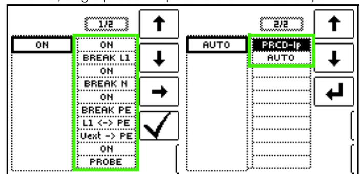
PRCD-S, 3-phase: 18 parameters = 18 test steps
